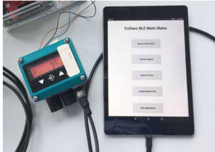
„Proof of concept“ ganz praxisorientiert: Die Daten werden per Funk (BLE) übertragen und sind für den Benutzer direkt auf dem Tablet sichtbar bzw. nutzbar.
