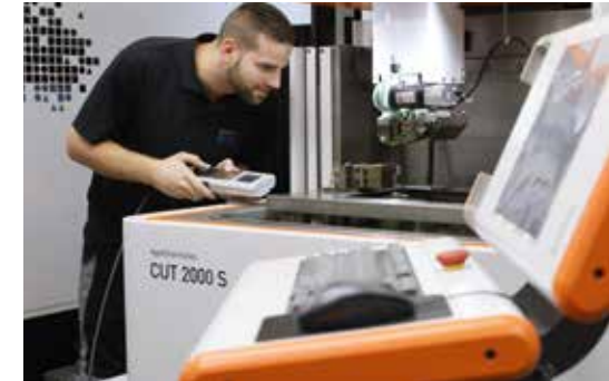
Die Produktion wird bei FWB Kunststofftechnik überwiegend über Bildschirme und Tablets gesteuert, beispielsweise im Werkzeugbau beim Drahterodieren.
