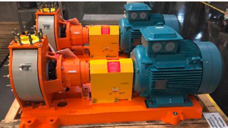
Dies ist eine exemplarische Pumpe. Der Motor ist blau, der Kupplungsschutz gelb, Pumpe und Grundplatte sind orange.
