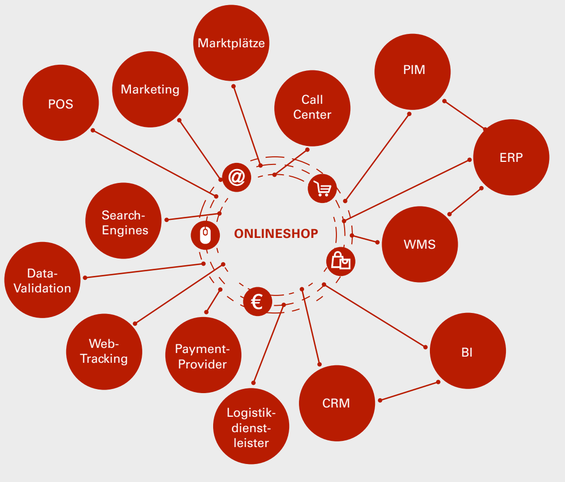
Abbildung 42: Beispielhafte Darstellung eines Onlineshop-Systems im Kontext einer vorhandenen IT-Infrastruktur
