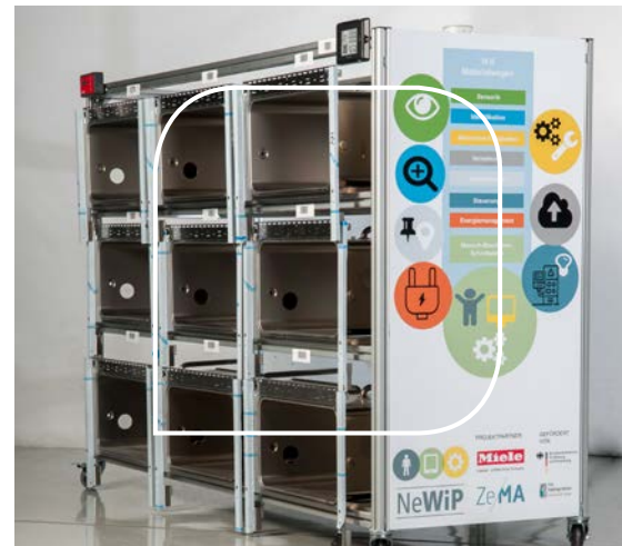
Auch vor Ort: Vernetzte Materialwagen zur leichteren betriebsübergreifenden Produktionsplanung und -steuerung.
