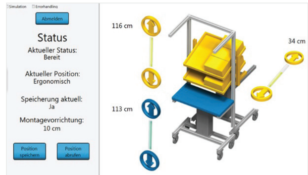
Abbildung 3: Benutzeroberfläche des adaptiven Montagearbeitsplatzes
