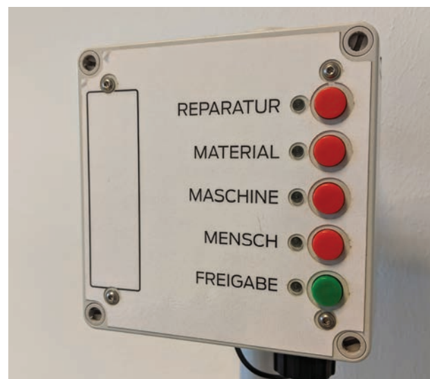
Abbildung 4: IoT-Box mit Rückmeldungen für Reparatur, Material, Maschine, Mensch und Freigabe
