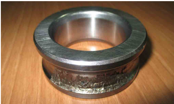
Foto 1: Schaden am Innenring eines oberen Lagers
