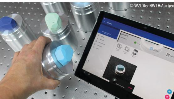
Der Prozess der Datenerfassung und der kontextabhängigen Informationsbereitstellung wird durch den Einsatz von BLE-Beacons verbessert. Erste Pilotanwendungen belegen den praktischen Nutzen, z. B. durch die automatisierte Rückmeldung von Abkühlungs- oder Trocknungsprozessen. Nichtsdestotrotz sollte ein derartiger Technologieeinsatz nur nach einer sorgfältigen Analyse der Prozesse und einer detaillierten Investitionsbewertung erfolgen.
