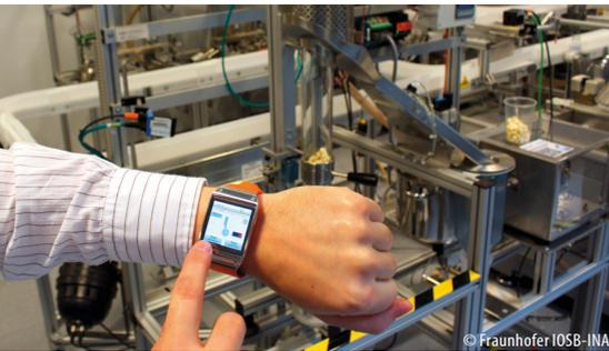
Bei der Steuerung der Produktionsanlage die Hände frei hat man mit einer handelsübliche Smartwatch.
