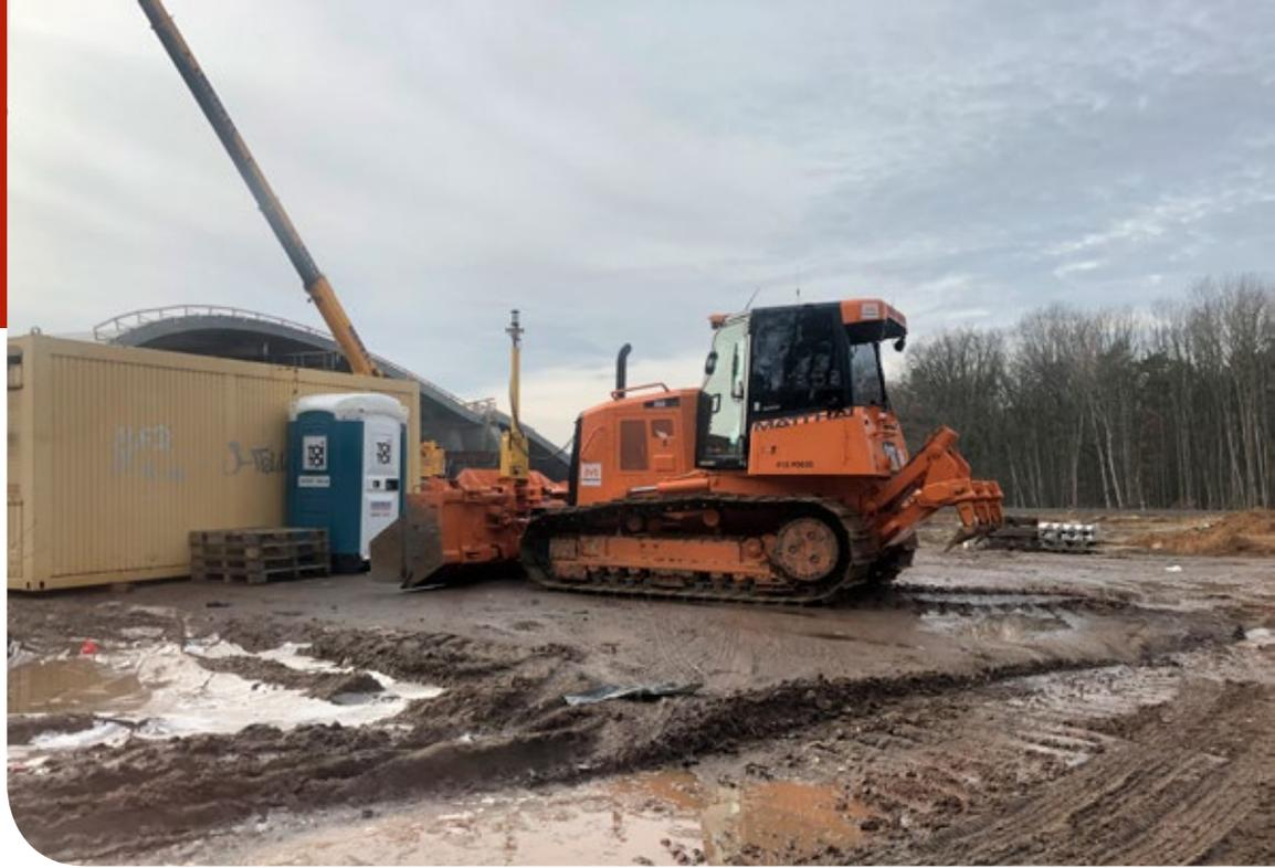
Abb. 4: Hybridbagger auf der Baustelle im Einsatz
